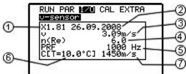
Figur 68: Givarnas status och evaluering av hastighetsmätning
