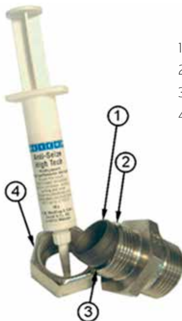
Figur 15: Delar som ska smörjas in med fett
