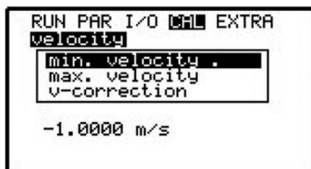
Figur 75: Gränsvärden för mätning av flödes hastighet
