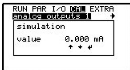
Figur 78: Simulering av analoga utsignaler
