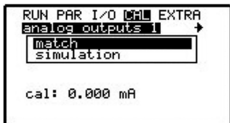
Figur 77: Kalibrering av analoga utsignaler
