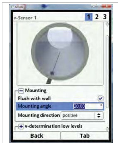
Fig. 7-40 Flush-monterad sensor kristall vid rät reflexionsvinkel
